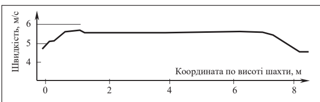
Рис. 5. Швидкість потоку у вертикальній шахті дегідрататора (вар. 1)
